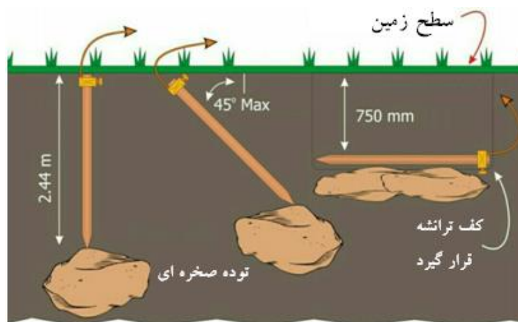
شکل (۶): صورتهای مجاز اجرای الکترودهای میله ای (NEC : 2014, Art: 250.53)
