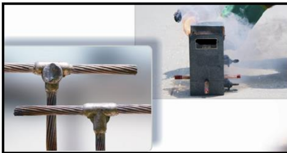
شکل (۹): جوش آگزوترمیک (احترافی)
